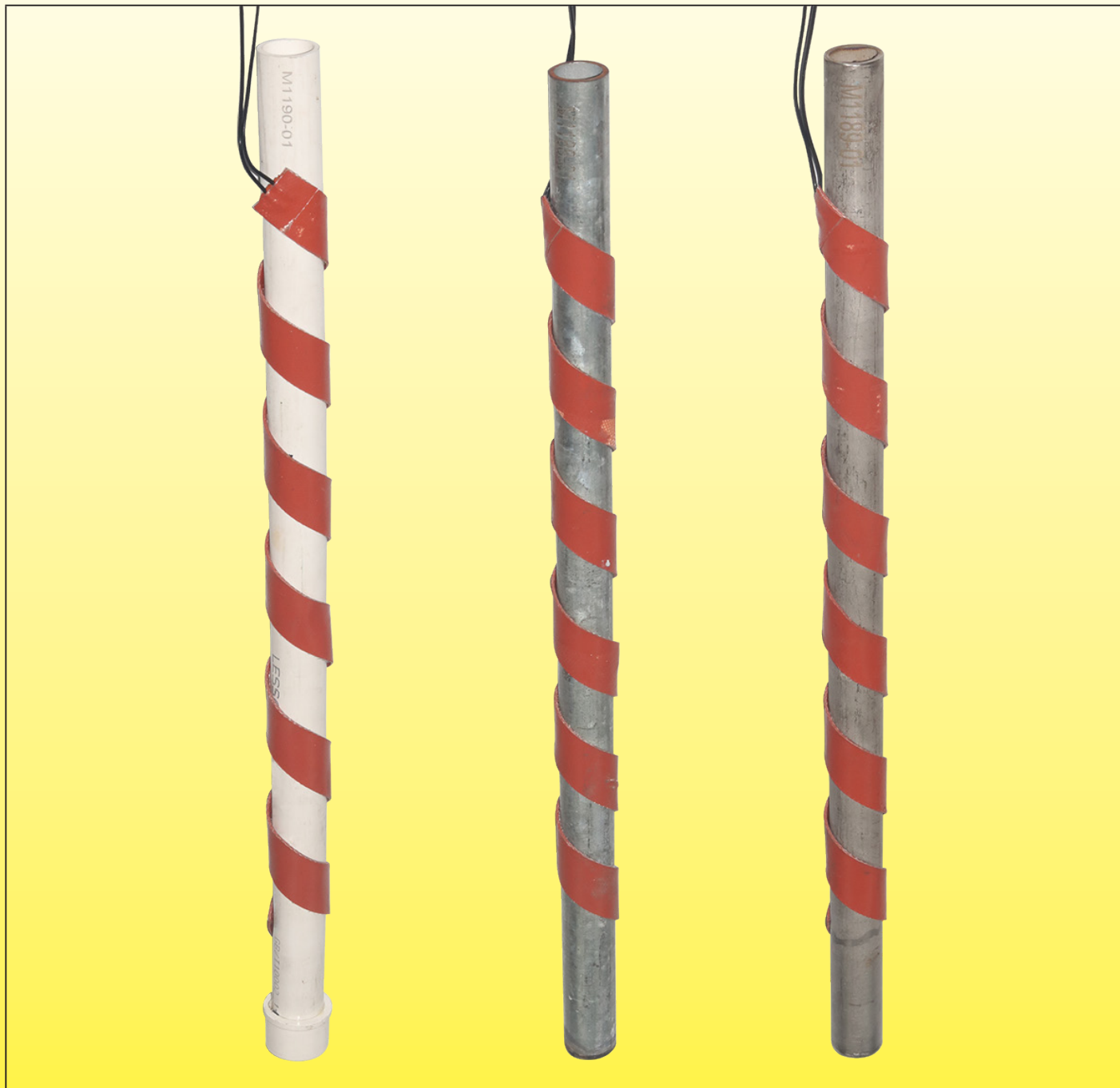
Bedingungen der Vergleichstests: Silikonheizbänder gewickelt auf Rohre mit einem Außen- \varnothing von 25mm, aus PVC-U, verzinktem Stahl und Edelstahl
