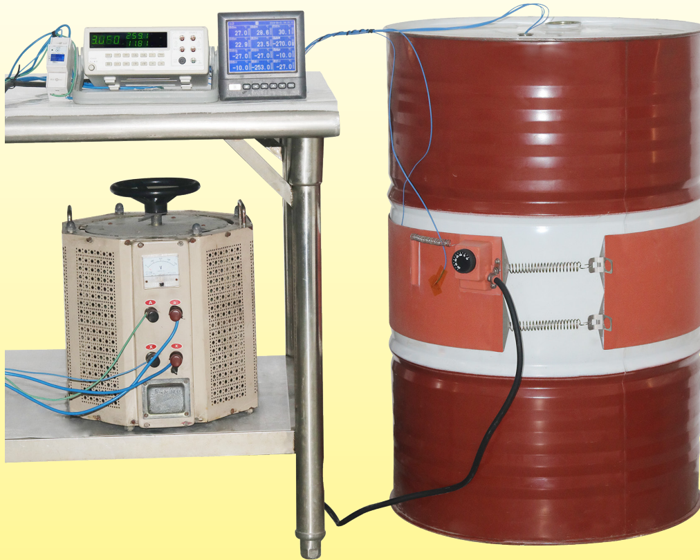
Temperaturverlauf in Abhängigkeit von der Zeit in einem 220Liter-Metalfass, gefüllt mit Wasser, beheizt durch einen Silikon-heizgurt von 200mm Breite, ohne Wärmeisolation, Leistung 2250W (Oberflächenlast 0,75W/cm 2 ).
